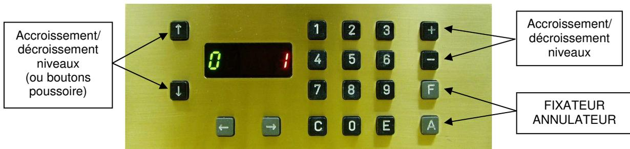
Il est toujours possible de brancher, par les cartes d'entrée, les boutons poussoir (1-32) et les commandes FIXATEUR, ANNULATEUR, ACCROISSEMENT, DECROISSEMENT CONTINU. Si ces commandes sont branchées elles fonctionnent en parallèle.
